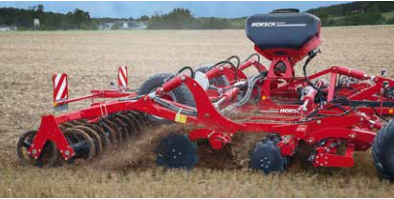
Joker RT в агрегате с опциональной мини-сеялкой MiniDrill: трубчатые сошники с заделкой семян перед катком
