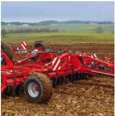
Глубина обработки регулируется изменением положения опорных колес
