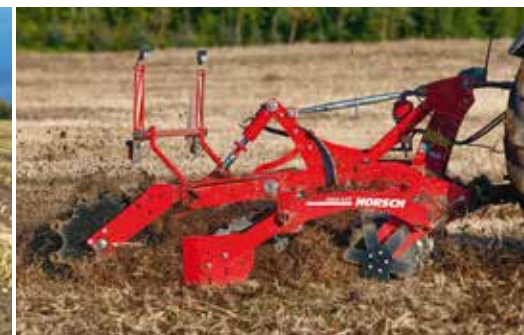
Надёжная система дисков (DiscSystem) обеспечивает оптимальное качество перемешивания и выравнивания поверхности
