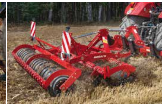
Joker/Mono TG – компактная разборная комбинация глубокорыхлителя и короткой дисковой борона
