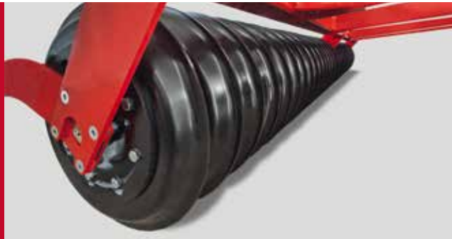
Закрытый каток SteelDisc для дополнительного крошения
