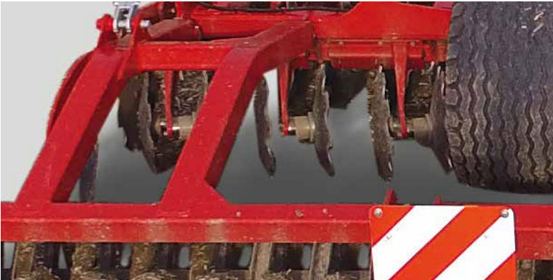
Монтаж двух дисков на одной стойке увеличивает свободное пространство в рабочей зоне машины
