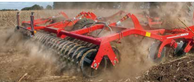
Joker создает мелкокомковатую структуру почвы и равномерно уплотненное строение обработанного слоя, что благоприятствует быстрому появлению всходов
