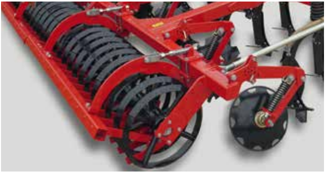
Каток RollCut создает хорошую структуру на средних, не каменистых почвах
