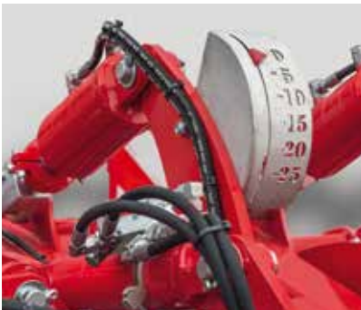
Опция для Joker 5/6/8 RT: гидравлическая регулировка глубины хода
