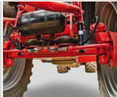
Высокий рабочий просвет и гладкое днище машины, подрессоренная ось, опционально с пневмоподвеской.
