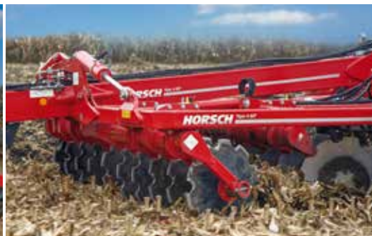
Двухрядная система дисков (DiscSystem) Эффективно прорезает и измельчает даже толстый слой крупнотельных пожнивных остатков
