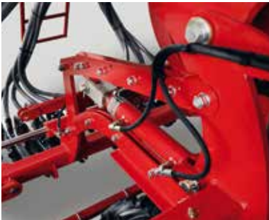
Pronto TD Удобное регулирование глубины заделки семян с помощью алюминиевых упоров
