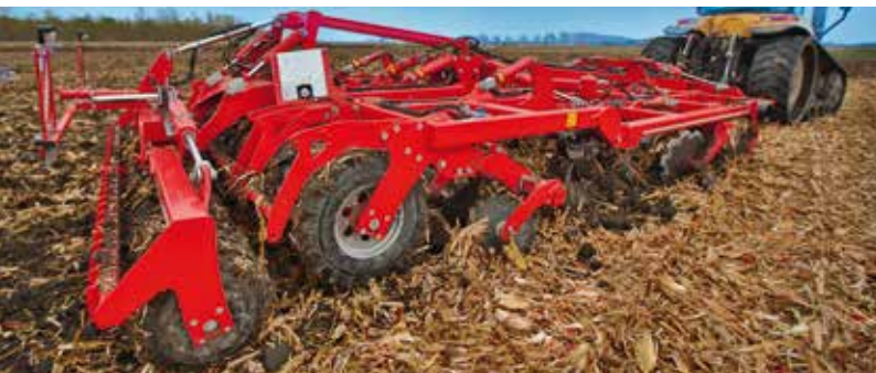
Шинный почвоуплотнитель в комбинации со стальным катком SteelDisc (опция)
