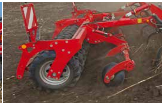
Выравнивающие диски Равномерное выравнивание перед колёсным почвоуплотнителем
