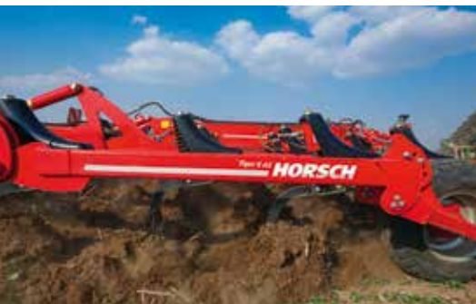
Система стоек TerraGrip Интенсивное перемешивание и рыхление благодаря многорядному расположению рабочих органов
