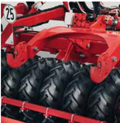
Задняя навеска на раме Tiger с разъёмами гидро и электросистем
