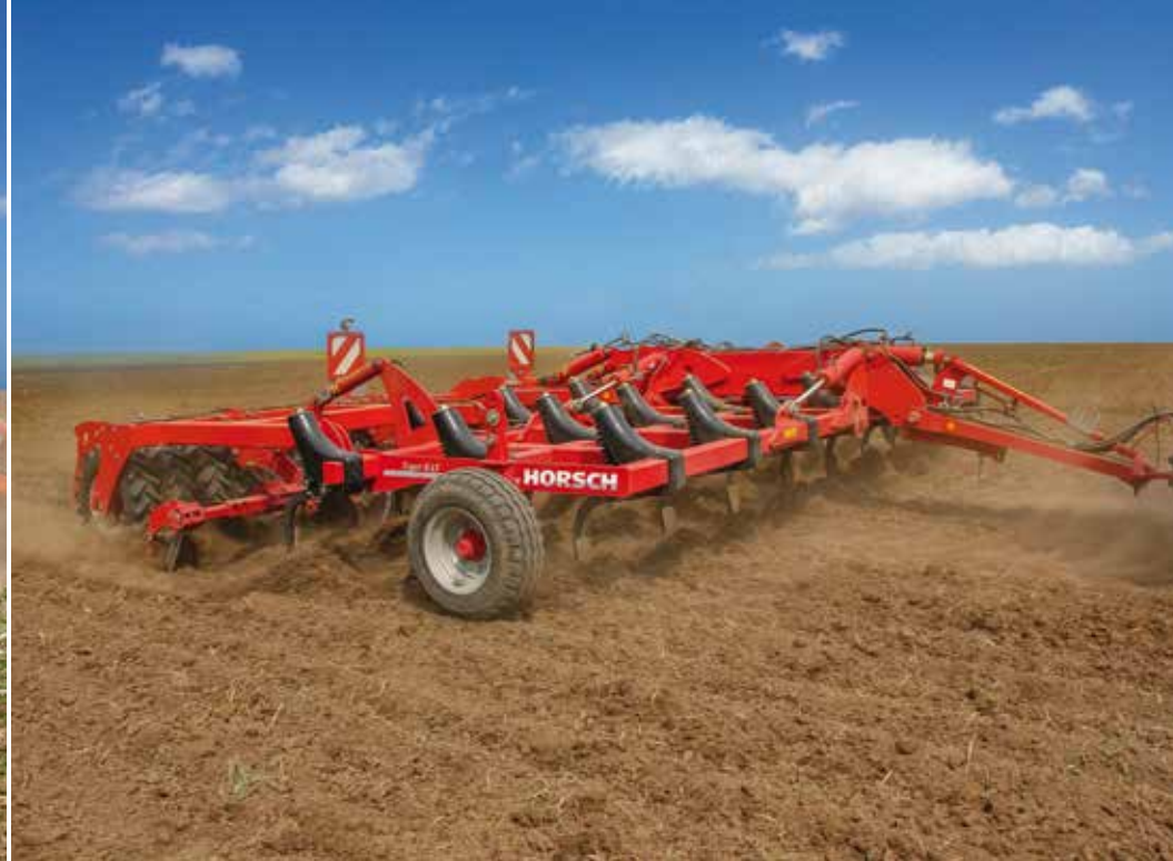
Tiger LT – компактный культиватор с малым тяговым сопротивлением
