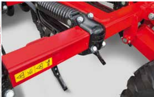
Стойки TerraGrip с защитой до 770 кг
