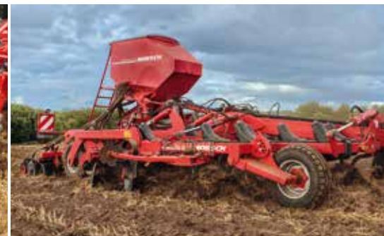
Pronto TD Навесная универсальная сеялка с дисковыми сошниками TurboDisc
